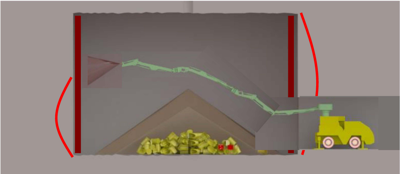
Abbildung 50: Ausbauen der Stöße mit Spritzbeton
