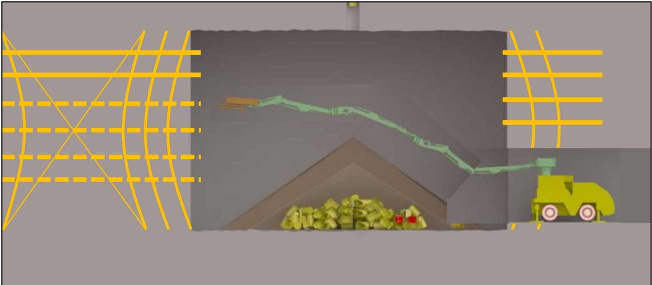
Abbildung 54: Verfestigen der Feste mit Gebirgsankern und Gebirgsinjektionen, Zustand nach der Injektion, Risse mit Injektionsgut gefüllt (gelb)
