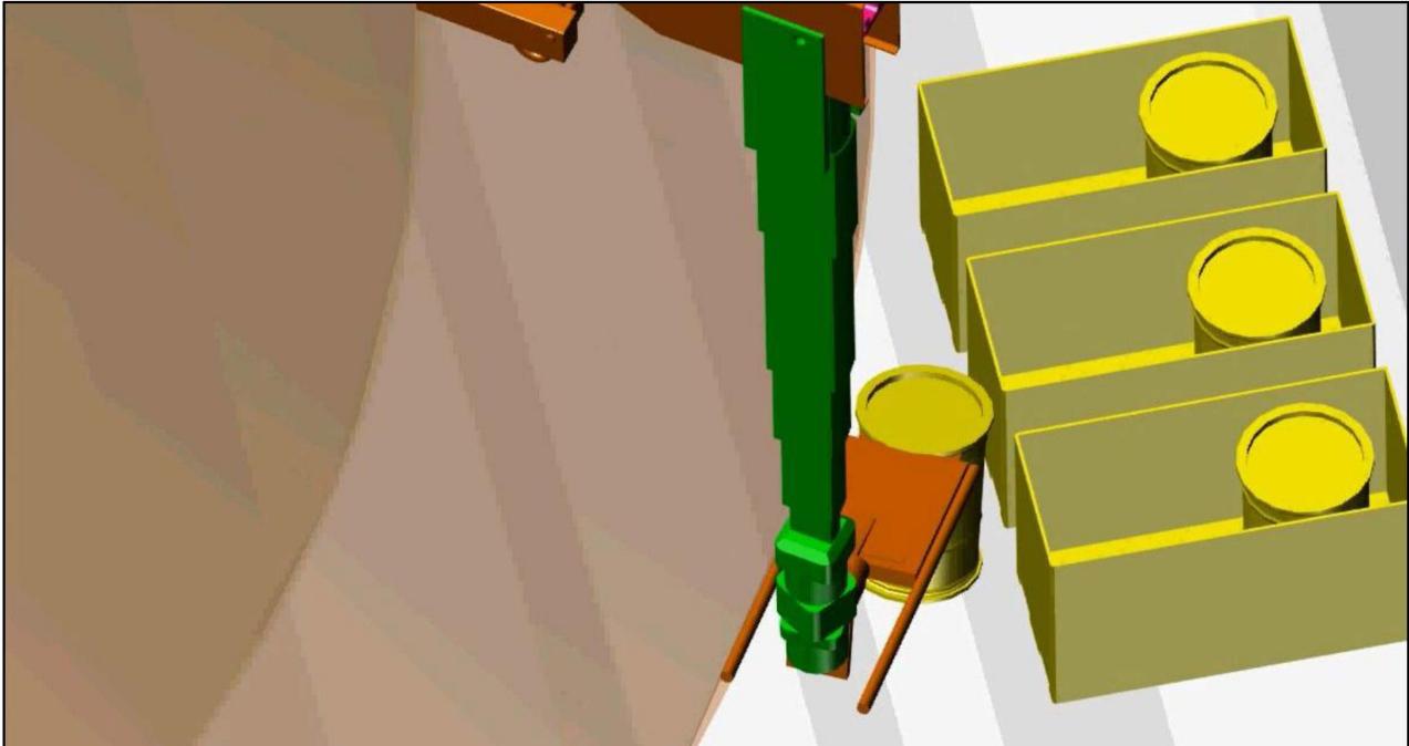
Abbildung 67: Befüllen der Innenbehälter
