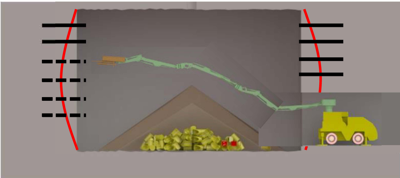
Abbildung 51: Ausbauen der Stöße mit kurzen Ankern
