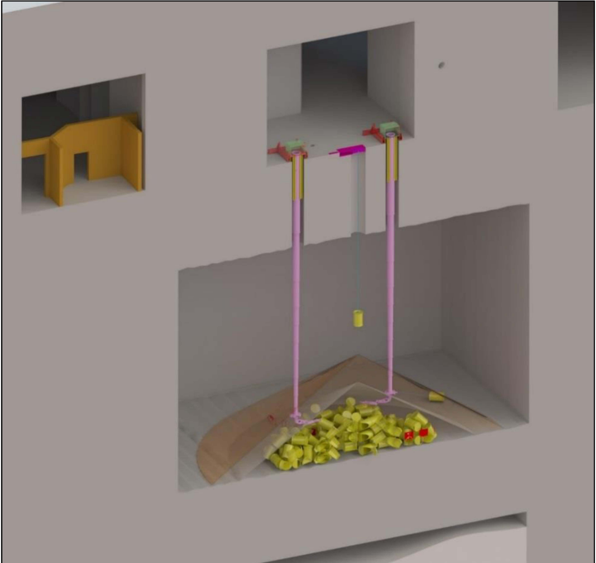
Abbildung 25: „Teilweise bestehende Anlagen“ mit Bergung der Gebinde über Krananlage und Beschickungsbohrung
